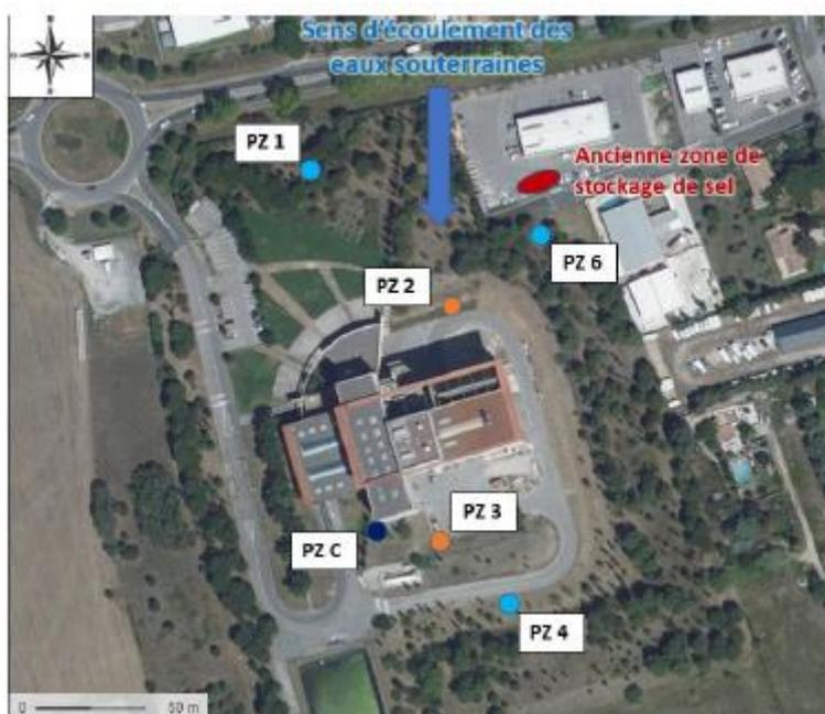
Figure 2 : Réseau de surveillance piézométrique du site
