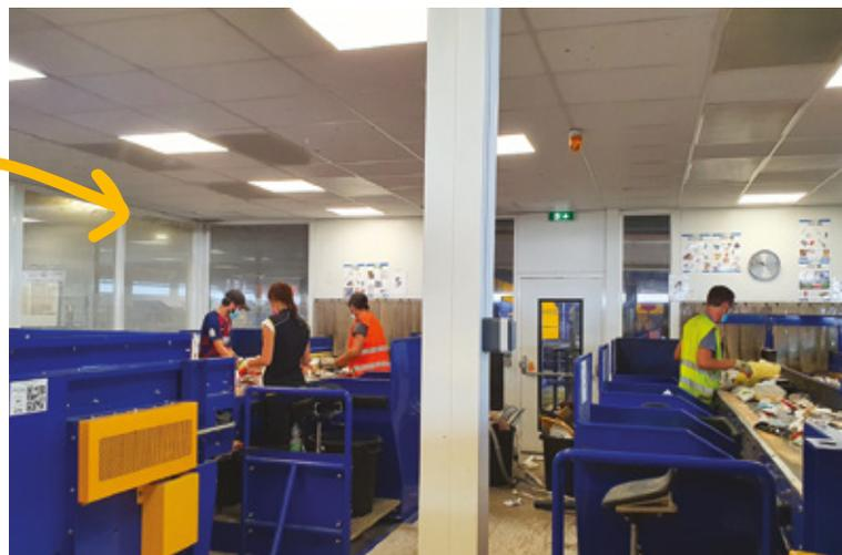
4. Chaque catégorie d'emballages est ensuite conduite vers des cabines de tri manuel pour une séparation plus fine des emballages en fonction de leur matériau. Les opérateurs rectifient également les erreurs réalisées par les machines. Il y a donc bien **des femmes et des hommes qui trient les déchets, à la main**. Les erreurs de tri (couches bébés, verre, ...) ou les emballages imbriqués impliquent donc une intervention humaine pour être retirés.
