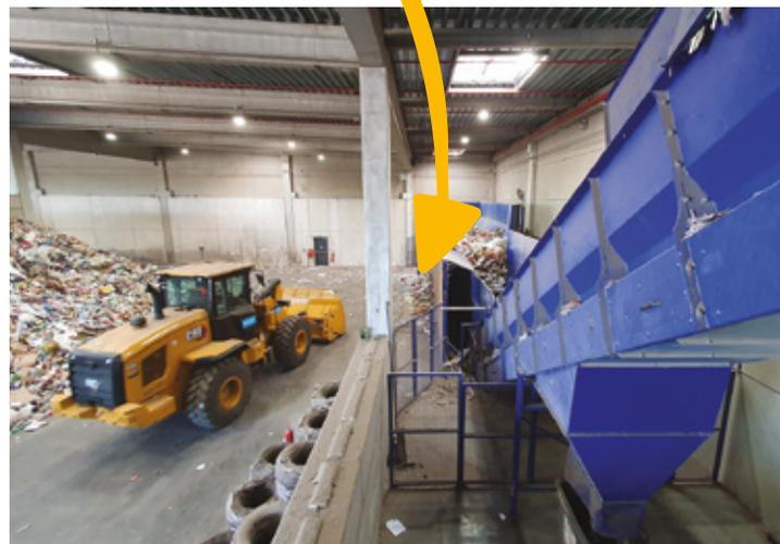
**3.** Les déchets, toujours en mélange, sont placés sur les premiers tapis roulants de la chaîne du tri, à l'aide d'une chargeuse, afin d'être séparés selon :
